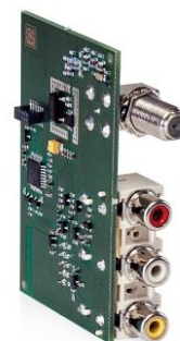
Рис.4. Модуль FM демодулятора ДМ-500FM. Разъем VIDEO не используется.
